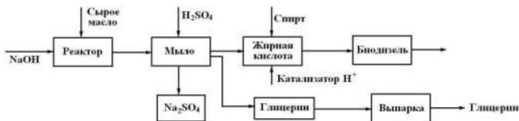
Рис.5. Технологическая схема процесса этерификации
