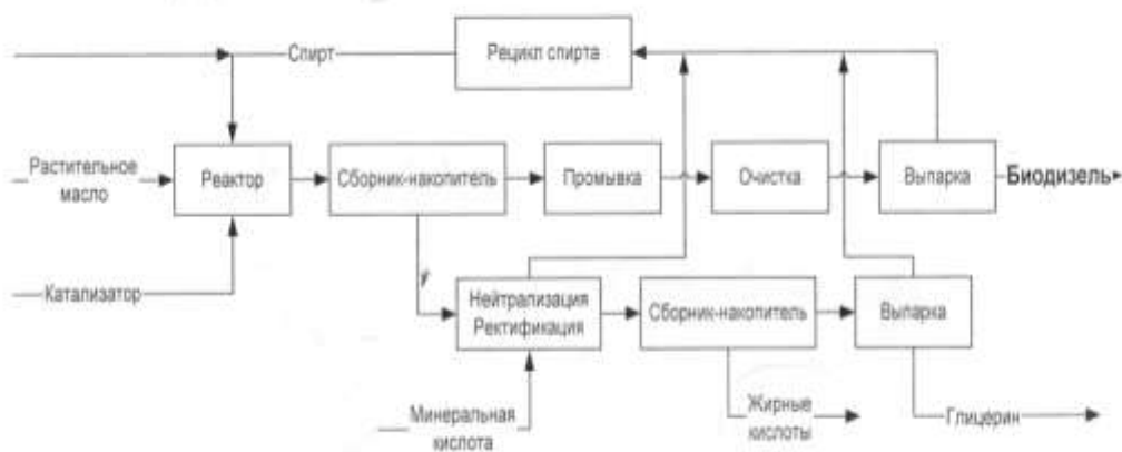
Рис.4. Технологическая схема получения биодизеля
