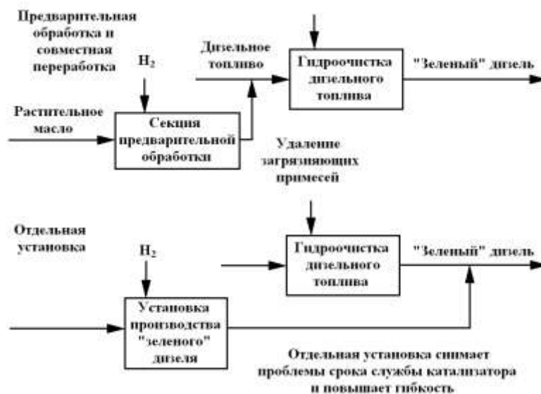
Рис. 6. Возможные варианты переработки растительных масел с целью получения дизельных топлив на основе смесового сырья
